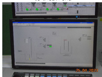
ภาพที่ 2-26 การควบคุมระบบบำบัดน้ำเสียด้วย DCS
